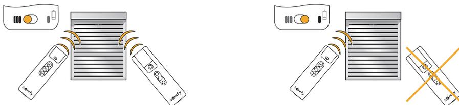
Sur la commande locale Situo A/M, vous pouvez isoler un produit de la commande générale en déplaçant le curseur sur la position "mode manuel" (I).
