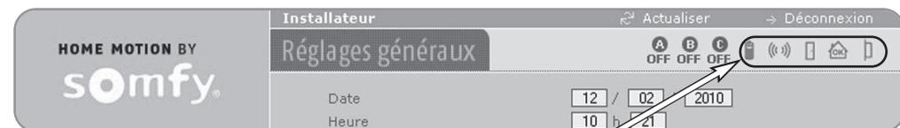
Permet de basculer sur la page «Liste des éléments du système» pour plus de détails en cas de pictogramme rouge
