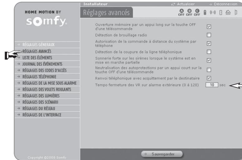
Temporisation des volets roulants liée au fonctionnement du détecteur de mouvement extérieur
