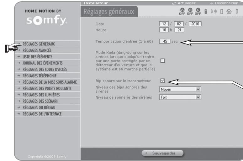
... avant le déclenchement de l'alarme, pour un détecteur d'intrusion en zone A Temporisée
